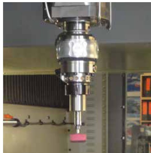
Exemple : système RSC dans le centre d'usinage
